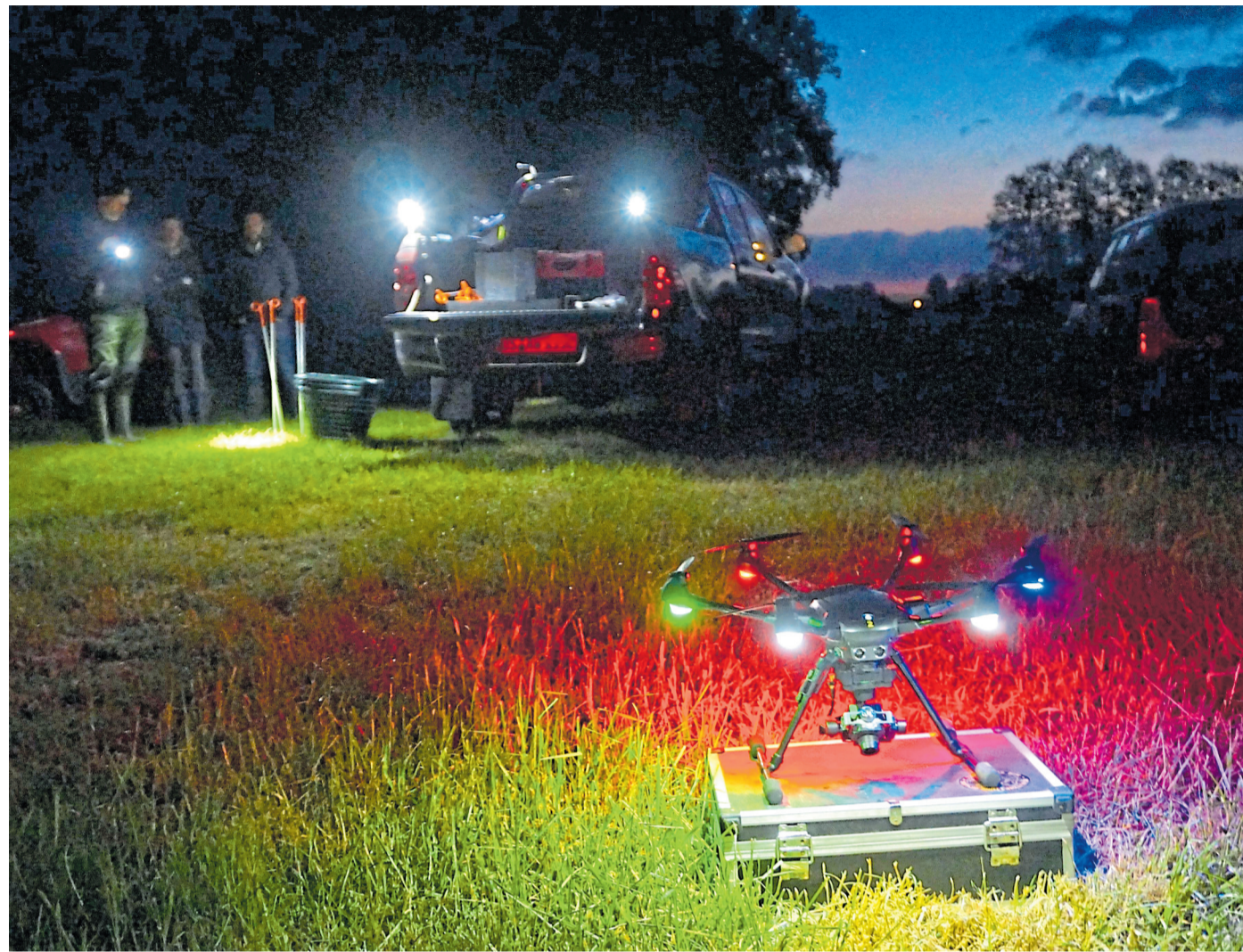
Die sechs Rotoren der Drohne leuchten in unterschiedlichen Farben. So weiß der Drohnenpilot wo vorne, hinten, rechts und links ist, wenn sich das Fluggerät samt Wärmebildkamera in luftigen Höhen befindet.
